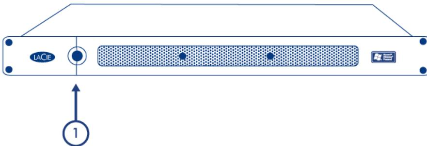
4. Die Netz-LED an der Vorderseite leuchtet blau auf, wenn die Netztaaste des Produkts gedrückt wird (außerdem sollten sich die Festplattenlaufwerke drehen).
