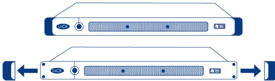
2. Schieben Sie die LaCie 4big Rack Office vorsichtig in einen freien Einbauplatz im Schrank. Verwenden Sie die Schrauben des Schrank, um das Gerät zu sichern.
