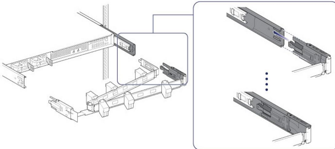
2. Lassen Sie den linken Außenanschlusspunkt in die äußere Schiene einrasten.
