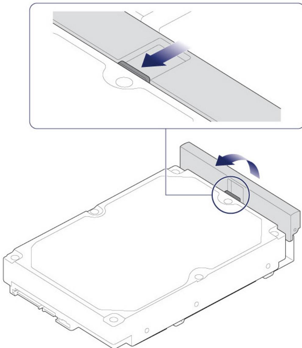
2. Platzieren Sie die Festplatte auf den Schienen für die LaCie 8big. Überprüfen Sie, ob die Festplatte korrekt auf den Schienen ausgerichtet ist, indem Sie sie vorsichtig vom SATA-Anschluss wegdrücken.
