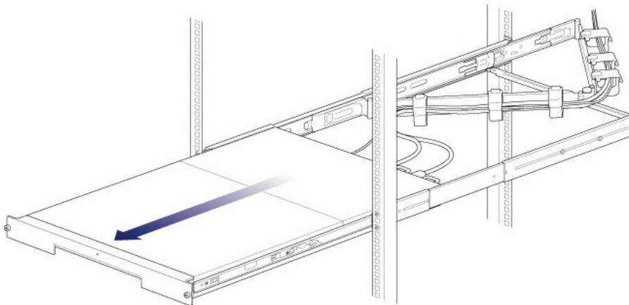
2. Lösen Sie die Abdeckung, indem Sie die beiden vorderen Riegel gleichzeitig zu sich heran drücken.
