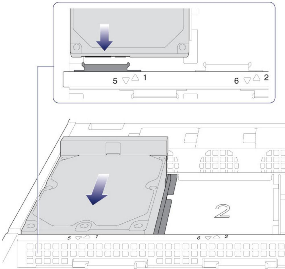
4. Schließen Sie die Festplattenverriegelung.
