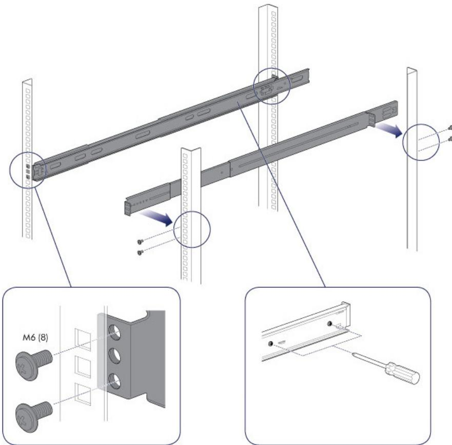
3. Schieben Sie die LaCie 8big in das Rack. Um die Führungsschienen zu entsperren, ziehen Sie die Schienenbefestigungen auf jeder Seite zu sich heran. Ein hörbares Klicken zeigt an, dass die LaCie 8big fest am Rack befestigt ist.
