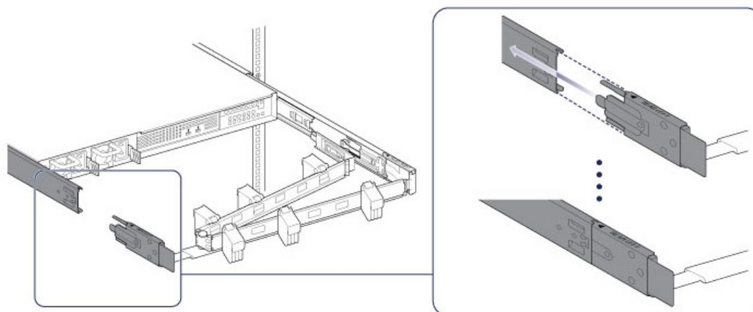
3. Führen Sie den rechten Innenanschlusspunkt in die innere Rack-Schiene.
