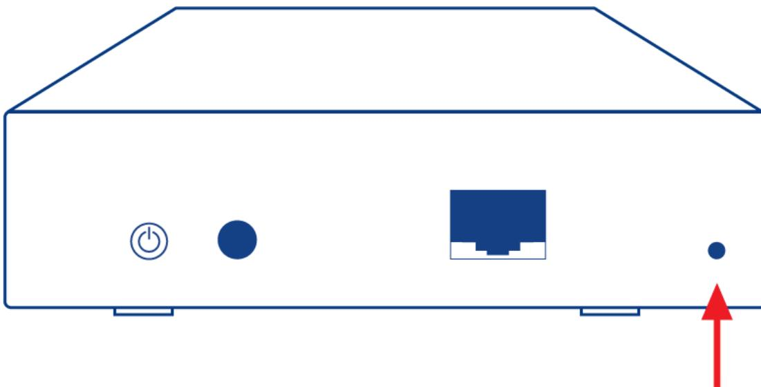
3. Führen Sie einen kleinen, spitzen Gegenstand (z.B. eine Büroklammer) in die schmale Öffnung des Reset-Knopfes. Wenn Sie Widerstand spüren, drücken Sie für 5 Sekunden weiter.
