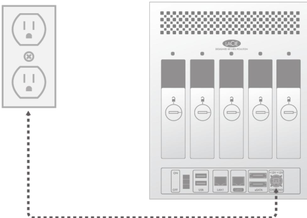
2. Schalten Sie das Gerät mit dem Netzschalter ein, welcher sich auf der Rückseite von dem Gehäuse befindet.
