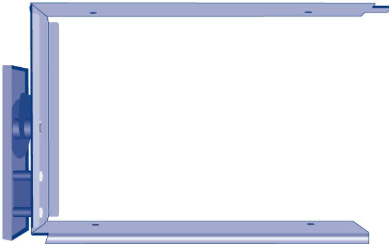
2. Viele Festplatten haben ein Etikett auf einer und die Platine auf der gegenüberliegenden Seite. Schieben Sie die Festplatte vorsichtig mit nach oben weisendem Etikett in den Laufwerkeinschub ein. Die Seite mit der Platine muss nach unten und der SATA-Anschluss nach rechts weisen. Richten Sie die vier Löcher für die Schrauben am Laufwerkeinschub an den vier für die Schrauben vorgesehenen Löcher an der Festplatte aus.
