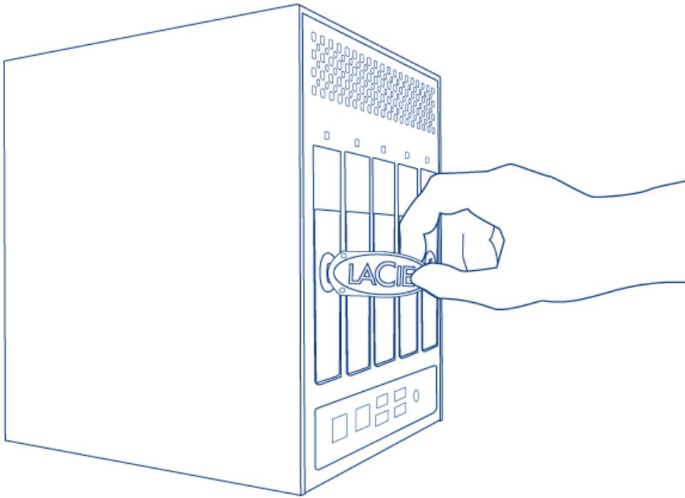
2. Greifen Sie mit dem Zeigefinger in die Aussparung hinter den Griff.
