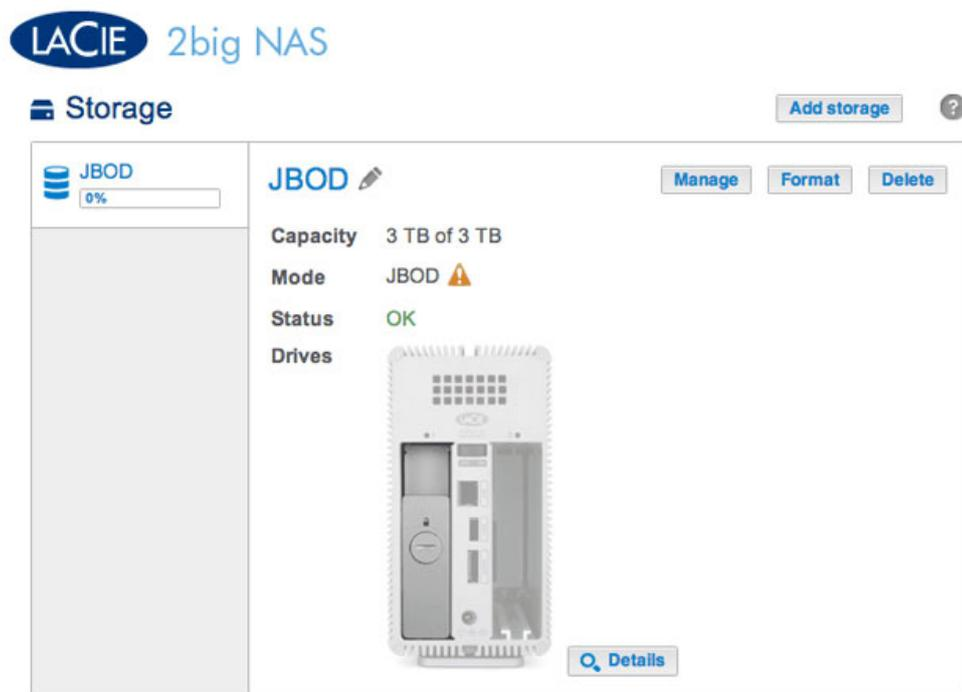
La capture d'écran ci-dessus montre un volume à disque unique configuré pour un JBOD (pour les instructions sur comment modifier le nom du volume par défaut par *JBOD*, voir [Outils de gestion des volumes](#)). Un volume JBOD peut être étendu grâce à l'ajout d'un nouveau disque au boîtier LaCie 2big NAS. Suivez les étapes ci-dessous pour ajouter un disque à votre volume JBOD :
