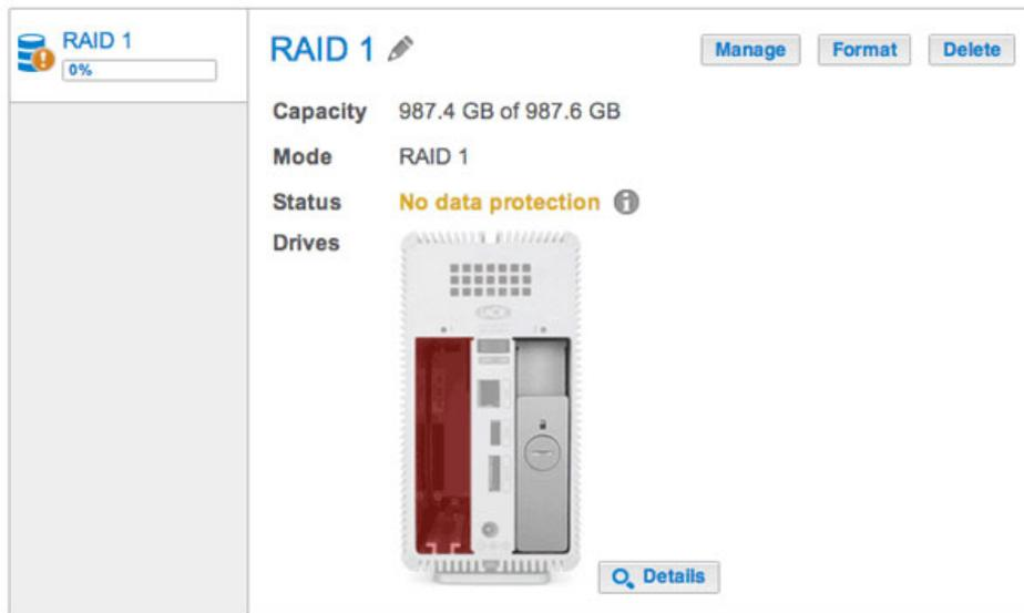
2. Insérez le disque de remplacement, tel qu'indiqué par les instructions données à la rubrique [Suppression/Insertion d'un disque dur](#). Le nouveau disque apparaîtra dans la liste de la page Stockage.
