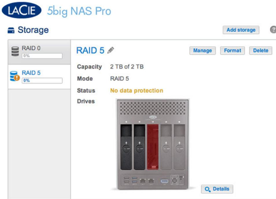
2. Insérez le disque de remplacement, tel qu'indiqué par les instructions données à la rubrique [Suppression/Insertion d'un disque dur](#). Le nouveau disque apparaîtra dans la liste de la page Stockage.
