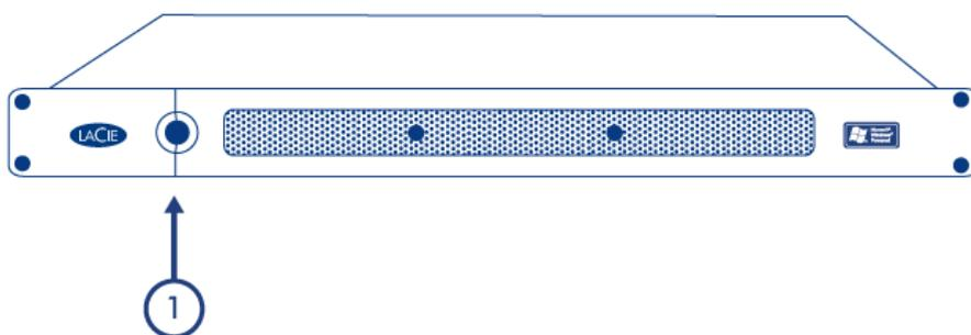
4. Le voyant DEL d'alimentation situé sur le panneau avant prend une couleur bleu lorsqu'on appuie sur le bouton d'alimentation (et les lecteurs des disques doivent tourner).
