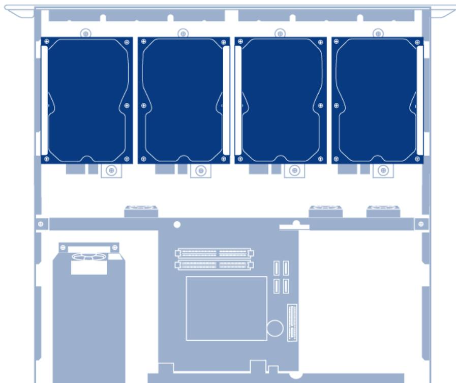
4big possède deux cadres de disque, chacune pouvant contenir deux disques durs de 3,5 pouces. Le cadre a des emplacements de montage pour les disques SATA. Le cadre permet la conduction de la chaleur, la fréquence radio et une protection contre l'induction d'impulsions électromagnétique et sert également de protection physique.
