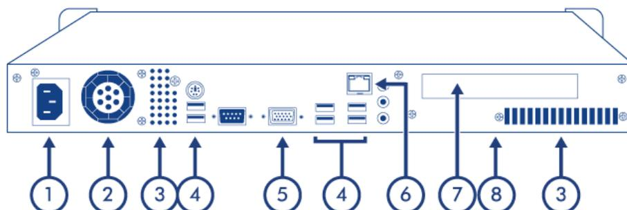
1. **Entrée d'alimentation** Il renvoie à l'endroit où vous branchez l'adaptateur CA fourni avec le disque. Voir [Installation](#).
