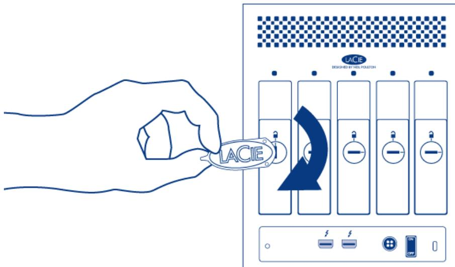
9. Mettre le produit sous tension. Avant de monter le disque sur votre bureau, vous devez le formater en tant que volume HFS+ à l'aide de Utilitaire de disque. Il pourra donc de ce fait être intégré dans une nouvelle matrice RAID comme décrit dans [raid](#). Pour remplacer un disque qui était dans une matrice RAID 1, référez-vous à [cet article](#) de Apple pour les instructions.
