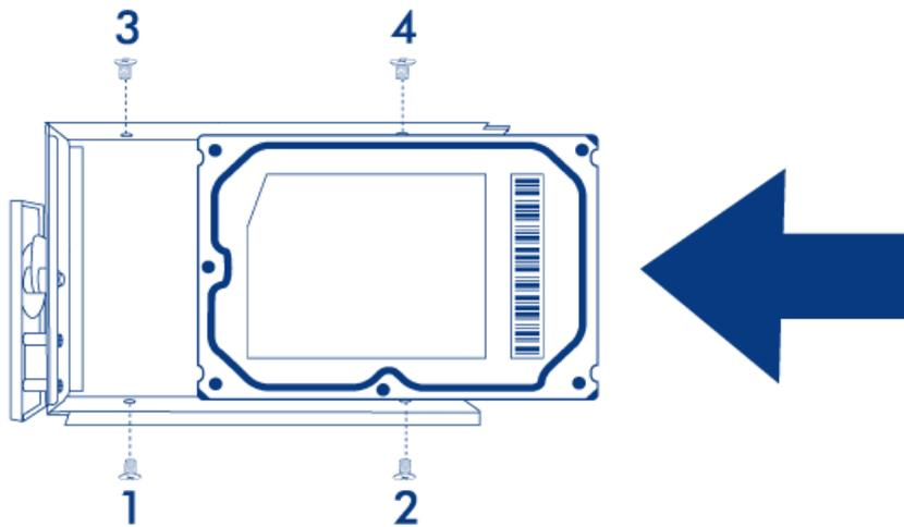
7. Introduisez le tiroir de disque plein. Introduisez délicatement le tiroir du disque dans le logement vide du lecteur. Poussez doucement la poignée du tiroir jusqu'à ce que ce dernier s'enclenche, et jusqu'à ce que la poignée du tiroir du disque soit alignée sur l'arrière du boîtier. Si vous voulez ajouter d'autres disques, insérez-les après.
