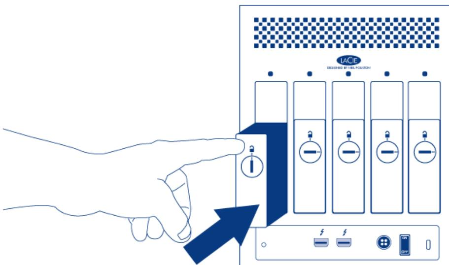
8. Utilisez l'outil de verrouillage du disque pour verrouiller le ou les tiroirs.
