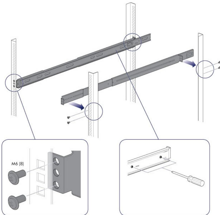
3. Faites glisser le LaCie 8big dans le rack. Pour déverrouiller les rails, tirez vers vous les attaches situées de chaque côté. Un déclic indique que le LaCie 8big est correctement fixé au rack.
