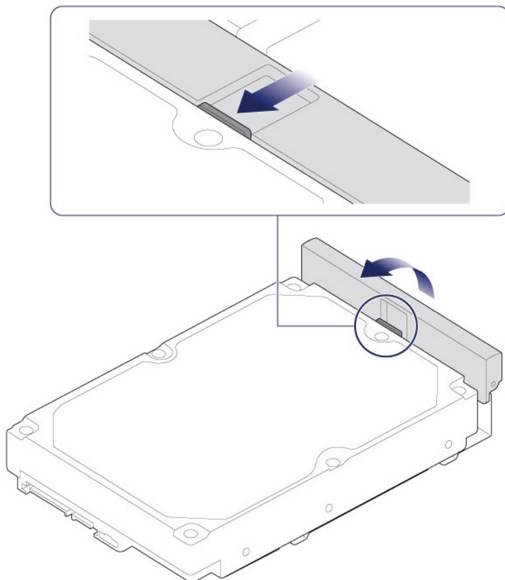
2. Placez le disque dur sur les guides correspondants du LaCie 8big. Vérifiez l'alignement du disque dur sur les guides en l'éloignant doucement de la connexion SATA.
