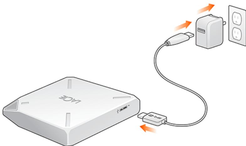
La batterie du disque LaCie Fuel se charge également lorsque celui-ci est connecté à un ordinateur, mais plus lentement. La durée de vie de la batterie varie selon le nombre de cycles de charge. Vous ne pouvez pas remplacer la batterie.
